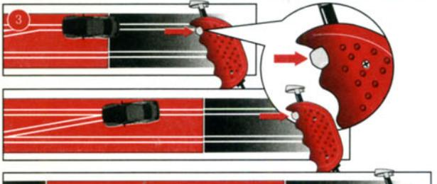
**D** 1+2 Achten Sie darauf, dass sich der Leitkeil des Fahrzeuges in der Spurrille befindet und die Doppelschleifer Kontakt zur Stromführungsschiene haben. Stellen Sie die Fahrzeuge auf die Anschluss-schiene. 3 Beim Spurwechsel muss der Knopf am Handregler solange gedrückt bleiben bis das Fahrzeug über die Weiche gefahren ist.
