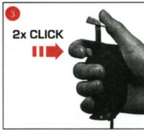
**D** Fahrzeug auf Bahn setzen, Weichentaste 2x drücken Abb. 1. Fahrzeug vorne anheben, zurücksetzen Abb. 2. Weichentaste 2x drücken Abb. 3. Programmierung wird durch Ton bestätigt. Alle Einstellungen sind gespeichert bis erneute Programmierung erfolgt.
